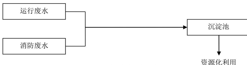
图 5.9-1 事故排水控制管线图
